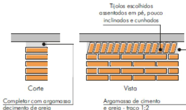
homogênea, de aspecto uniforme e consistência plástica recomendada. A quantidade a ser preparada deverá atender as necessidades dos serviços a executar em cada etapa. Serão rejeitadas as argamassas que apresentem vestígio de endurecimento, retiradas ou caídas dos revestimentos, sendo expressamente proibido tornar a amassá-la. A dosagem a ser adotada será 1:2:8 de cimento, cal e areia.
