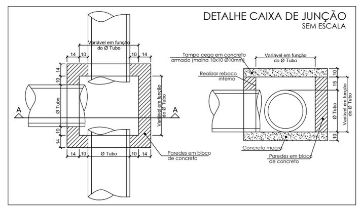
**DETALHE CAIXA DE INSPEÇÃO PARA TUBOS DE Ø60cm**
