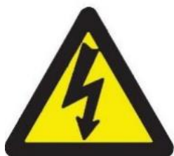
Figura 1 - Sinalização de alerta para quadros elétricos
