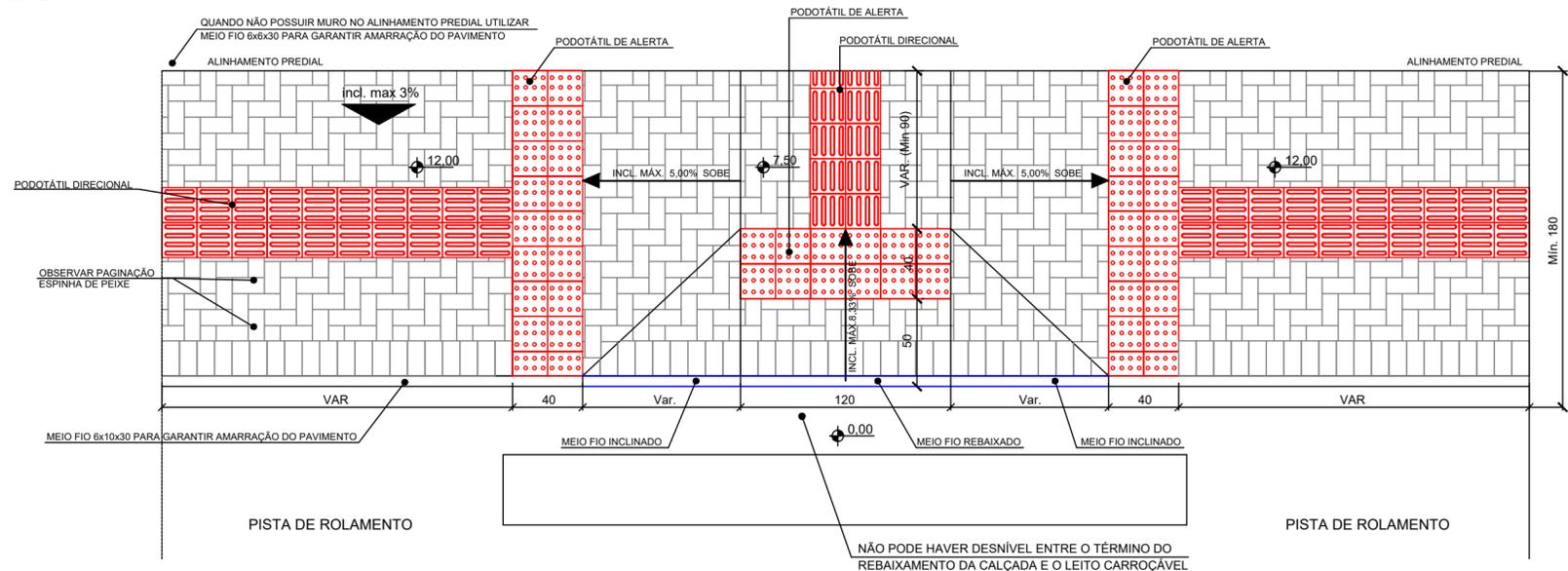
**NOTA:** O DETALHE SEGUE O QUE SOLICITA A NBR 9050/2020, ENTRETANTO É IMPOSSÍVEL RESPEITAR AS CONDICIONANTES DAS RAMPAS LATERAIS PARA RUAS COM INCLINAÇÃO IGUAL OU SUPERIOR A 5%.
