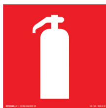
Sinalização do extintor conforme NR 16820
